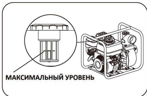
Рисунок 5. Максимальный уровень заполнения топливного бака.
