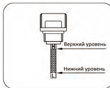
Рисунок 3. Отметки на масляном щупе.
