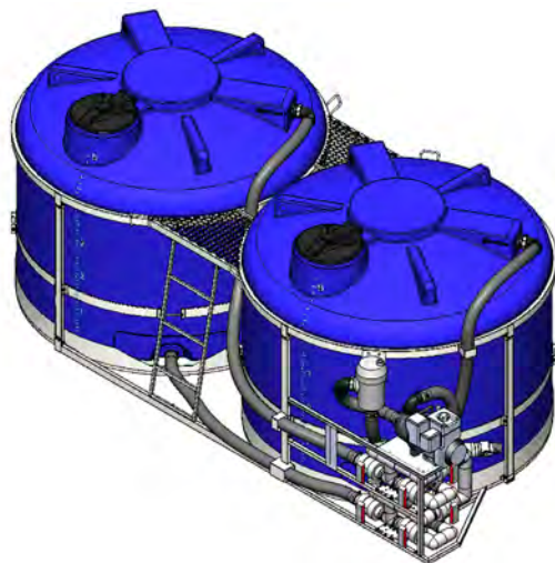
Комплекс насосный для СЗР/КАС 1275л/мин ПВХ d75мм на две емкости TRF
