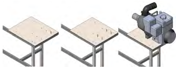
Установка мотопомпы Vanjo G3
