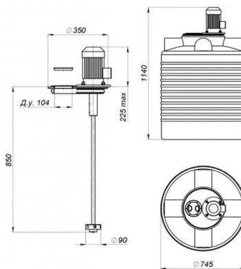
Мешалки предназначены для перемешивания жидкости с максимальной плотностью 1,3 г/см<sup>3</sup>, динамической вязкостью жидкой фазы - 6 Па/сек.
